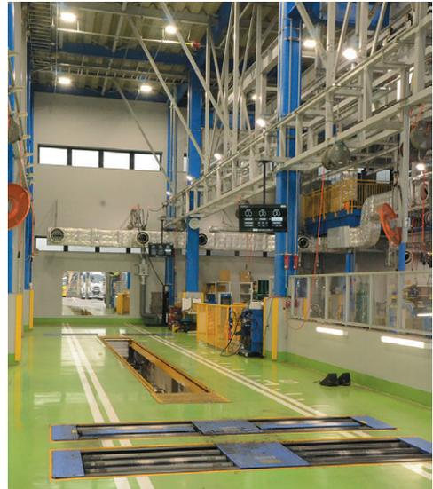
全自動の検査ライン。車検や完成検査をスピーディーに行なうためのレーン。効率の良い仕事で車両の稼働率向上に貢献する。
