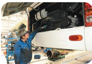
ユニバースのエンジンルームに手が届く高さに設定。太いポールを油圧でコントロールするため、安定性も良好だ
